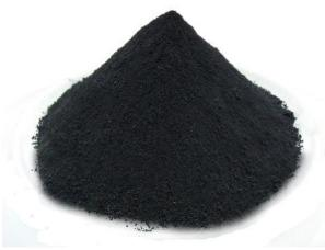
El grafito es el componente principal de gran parte de las escobillas de carbono que se usan en los motores eléctricos, permitiendo sus propiedades ajustar la lubricidad, densidad, dureza, desgaste y conductividad eléctrica de las escobillas. El grafito natural de alto nivel de pureza da unos óptimos resultados.
