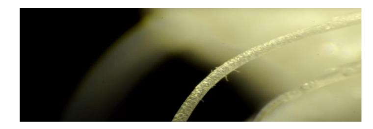
"Estas patas son tubos huecos, y el líquido se canaliza hacia abajo a través de estos tubos. Una vez que llega al fondo y se evapora, forma nuevos cristales que aumentan continuamente la longitud del tubo", dice McBride. "Al final, tienes un contacto muy, muy limitado entre el sustrato y el cristal, hasta el punto de que éstos van a rodar solos".
