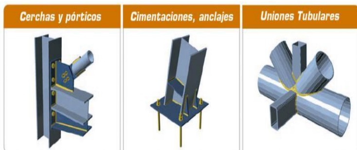
Fig. 1 Tipologías para el análisis de conexiones metálicas.
