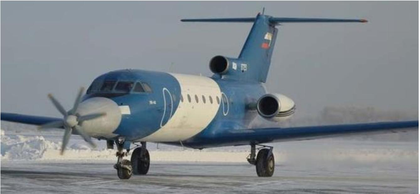
El primer avión eléctrico de producción rusa, fabricado sobre la base de un laboratorio volador aplicado a un Yak-40, realizó su primer vuelo de ensayo en el marco del salón aeroespacial MAKS 2021, que tiene lugar en la ciudad de Zhukovski (provincia de Moscú), reporta RIA Novosti.
